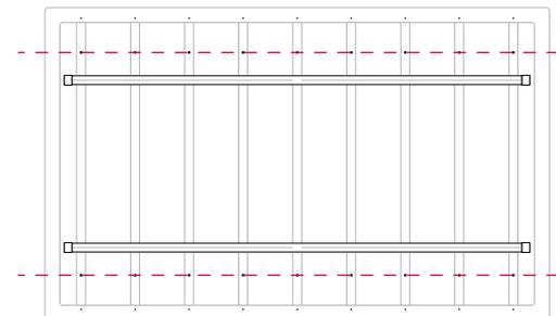
Die folgenden Schritte zeigen Dir wie Du mit dem mitgelieferten Befestigungssystem das Dachzelt am Dachgepäckträger festschrauben kannst. Falls Du über ein besonders breites Fahrzeug verfügst kannst Du zuvor die Monategschiene auf die vorgebohrte Lochreihe versetzen.
