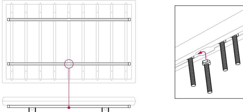
**3** Der Bügel wird auf die beiden Schrauben aufgesteckt und mit Sprengring, Unterlagscheibe und Sterngriffmutter fixiert.
