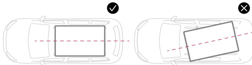
Montiere das Dachzelt möglichst mittig auf dem Dachträger.
