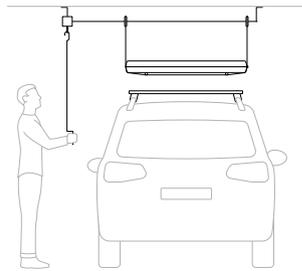
Nachdem der Dachträger montiert ist, kannst Du das Dachzelt auf Deinem Fahrzeug platzieren. Ob Du den Eingang auf der Fahrer- oder Beifahrerseite montierst kannst Du frei bestimmen.
