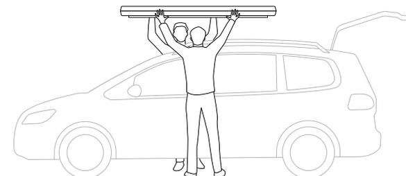
Um das Dachzelt auf dem Fahrzeug montieren zu können empfehlen wir Dir mindestens mit 2, besser mit 4 Personen zu arbeiten.
