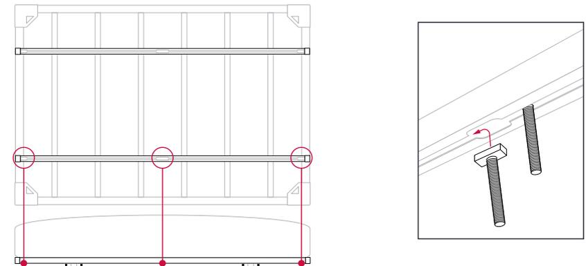
**3** Der Bügel wird auf die beiden Schrauben aufgesteckt und mit Sprengring, Unterscheibe und Sterngriffmutter fixiert. Richtige Schraubenlänge wählen.
